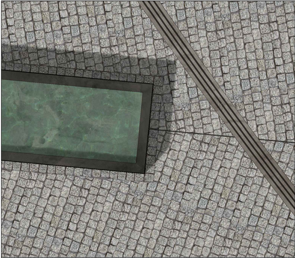
01. DETAIL- vodní prvek, ocelový pásek a vodící linie
