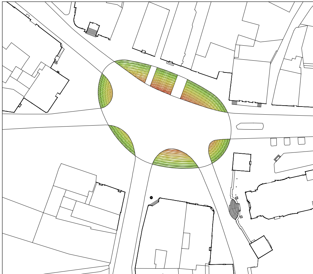
07. SÁZENÍ - květiny budou sázeny v pravidelných sponech a v ekvidistancích od řídicí křivky- améby, vzdálenost je zvolena 25 cm, výběr rostlin bude podřízen požadavku na co největší pestrost a dobu květu v průběhu celého produktivního období
